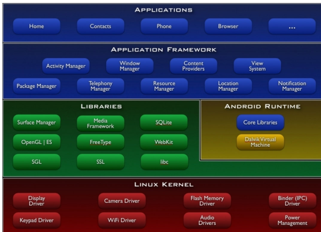
Abbildung 2.2: Android Systemarchitektur (Quelle: [31])
